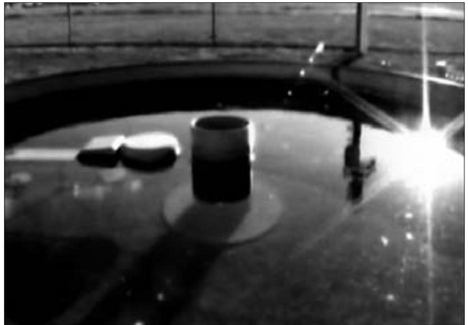
Mit solchen genormten Behältern wird rund um die Erde in tausenden Messstationen die Wasserverdunstung gemessen.
